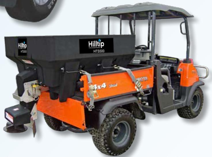
Der HTS500 Streuer ist ein ultra-robuster Streuer für Salz & Salz/Sand-Gemisch, entwickelt für den Winterdienst. Das widerstandsfähige Polymer-Design bietet einen **HERVORRAGENDEN MATERIALFLUSS**, **EINFACHE INSTALLATION** & ist nahezu **WARTUNGSFREI**.
